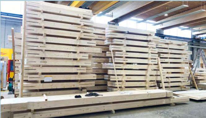
Die Wandelemente werden in der Werkhalle vorgefertigt und später auf der Baustelle zusammengebaut.
