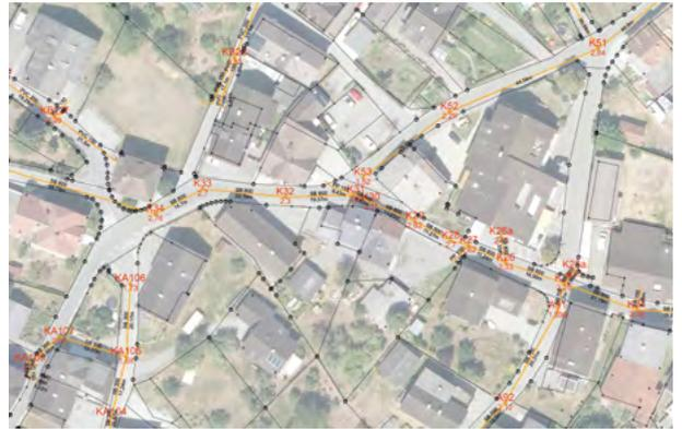
Darstellung des Kanals im GIS-System mit Schachtbezeichnungen, Rohrdurchmesser etc.
