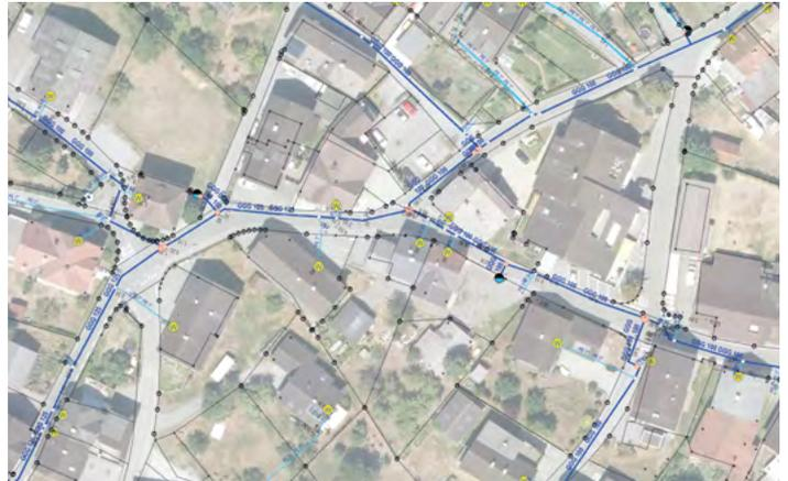
Darstellung des Wasserleitungsnetzes im GIS-System mit Leitungsdurchmesser und Leitungsmaterial etc.
